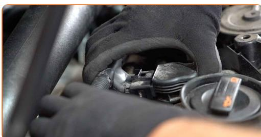
Смяна на: запалителни свещи – VW Transporter VI Микробус (SGB, SGG, SGJ). Експертите на AUTODOC препоръчват:
