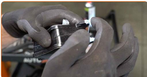
Смяна на: спирачни накладки – VW Transporter VI Микробус (SGB, SGG, SGJ). Експертите на AUTODOC препоръчват:
