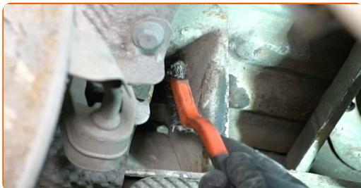
**Смяна на: амортизьори – VW Transporter V Микробус (7HB, 7HJ, 7EB, 7EJ, 7EF, 7EG, 7HF, 7EC). Съвет от AUTODOC:**
