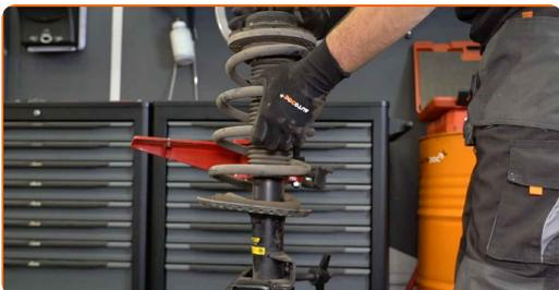
Смяна на: пружини – VW Transporter T5 Микробус (7НВ, 7НЈ, 7ЕВ, 7ЕЈ, 7ЕФ, 7ЕГ, 7НФ, 7ЕС). Експертите на AUTODOC препоръчват:
