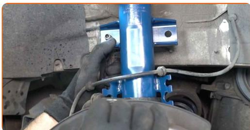
69 Затегнете крепежния елемент, който свързва стабилизатора с макферсона. Използвайте тръбен ключ №18. Използвайте динамометричен ключ. Затегнете я с усилие от 60 Nm.+45°
