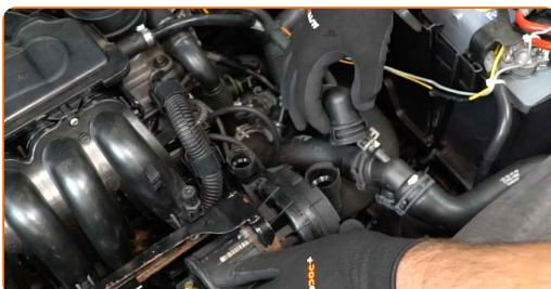
**4** Покрийте каналите на помпата за вторичен въздух с микрофибrena кърпа, за да предотвратите попадане на прах и замърсявания вътре.
