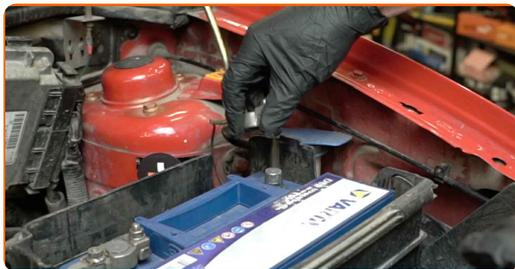
**6** От дясната страна, откачете маркуча на клапана за вентилация на картерните газове от капака на двигателя.
