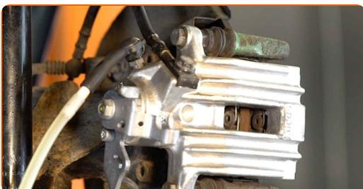
**26** Монтирайте жилото на ръчната спирачка в скобата на спирачния апарат. Използвайте клещи за водна помпа.
