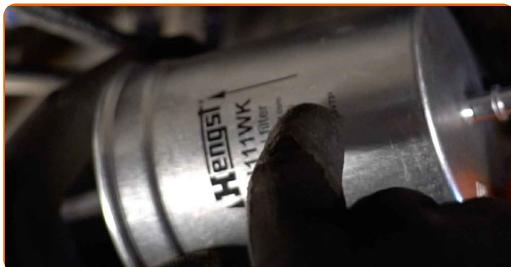
Смяна на: горивен филтър – VW Phaeton (3D1, 3D2, 3D3, 3D4, 3D6, 3D7, 3D8, 3D9). AUTODOC препоръчва:
