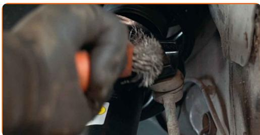
**33** Развийте крепежния елемент, който свързва стабилизатора с макферсона. Използвайте тръбен ключ №18. Използвайте тресчотен ключ.
