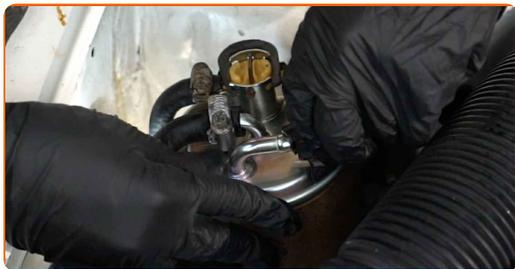
**18** Завийте крепежния елемент свързващ горивопровода към корпуса на горивния филтър. Използвайте тръбен ключ №7. Изполвайте тресчотен ключ.
