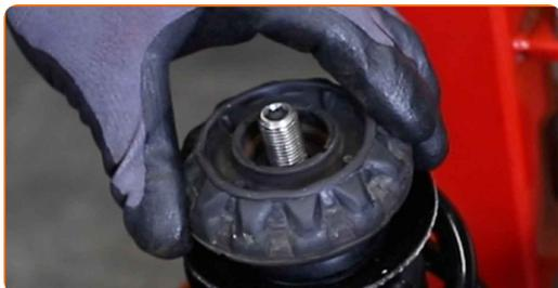
**31** Стегнете гайката на пръта на амортисьора. Използвайте HEX №Н7. Използвайте 21 мм камък за гайки на амортисьори. Използвайте динамометричен ключ. Затегнете я с усилие от 60 Nm.
