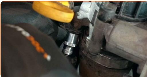
8 Разхлабете крепежния елемент на маркуча за подаване на въздух. Използвайте тръбен ключ №7. Използвайте тресчотен ключ.
