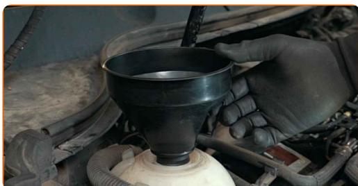
66 Налейте охлаждачна течност в резервоара за охлаждачна течност.
