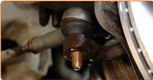
**17** Завийте крепежната гайка, която свързва кормилния накрайник с шенкела. Използвайте тръбен ключ №19. Използвайте тресчотен ключ.
