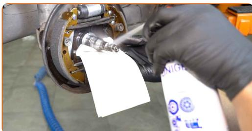
**12** Монтирайте нов спирачен апарат заедно с главината на колелото.
