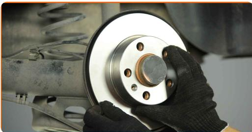
**19** Затегнете фиксиращите болтове на спирачния диск. Използвайте кръстата отвертка. Използвайте динамометричен ключ. Затегнете я с усилие от 4 Nm.
