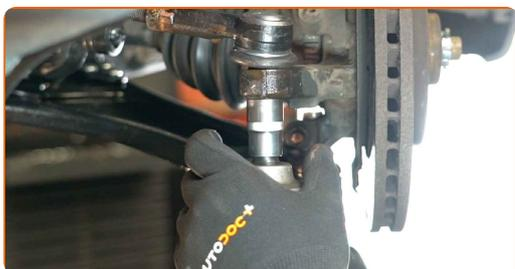
**17** Измерете и запишете дължината на свободната резба на кормилната щанга или запомнете броя на пълните обороти при демонтажа на детайла, за да запазите ъгъла на сходимост на колелата при монтажа. Използвайте дебеломер.
