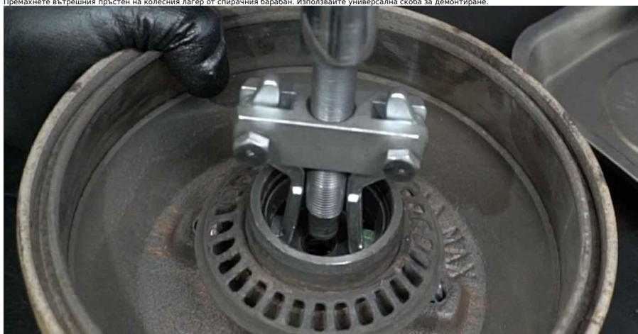
club.autodoc.bg 6-14 16 Премахнете външния пръстен на колесния лагер от спирачния барабан. Използвайте комплект дорници за втулки и лагери.
