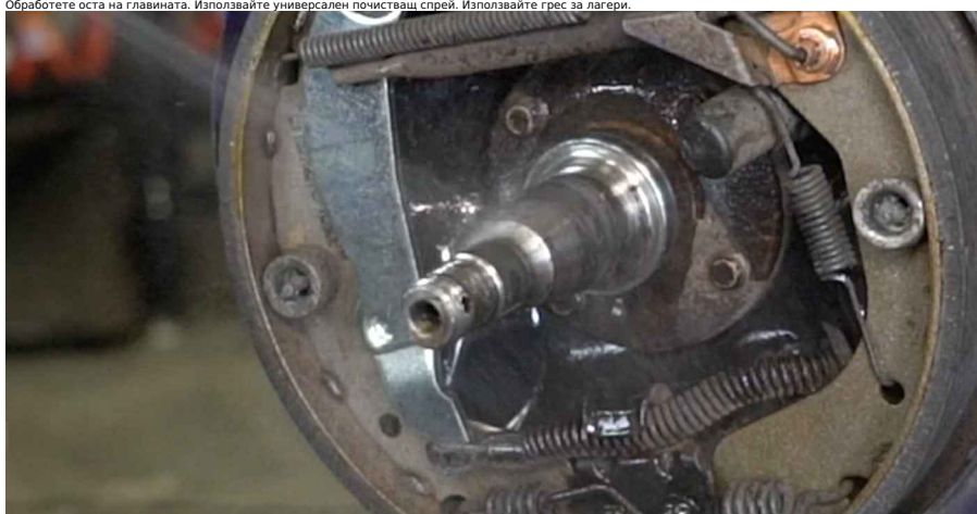
24 Монтирайте спирачния барабан заедно с лагера на главината на колелото.
