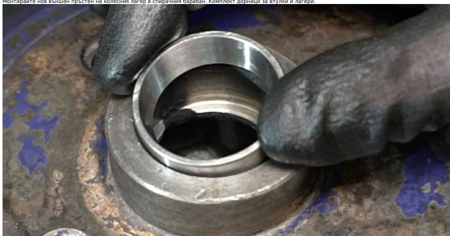
19 Монтирайте новия вътрешен пръстен на колесния лагер в спирания барабан. Комплект дорници за втулки и лагери.
