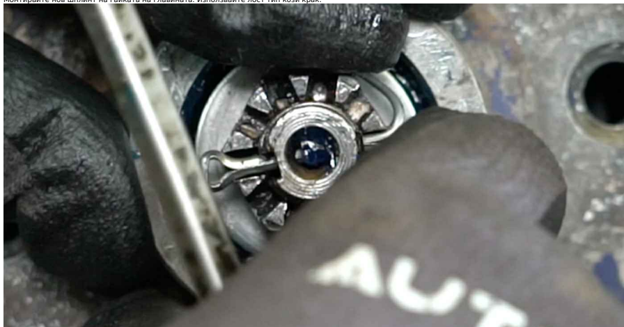
34 Поставете капачката на гайката на главината. Използвайте гумен чук.
