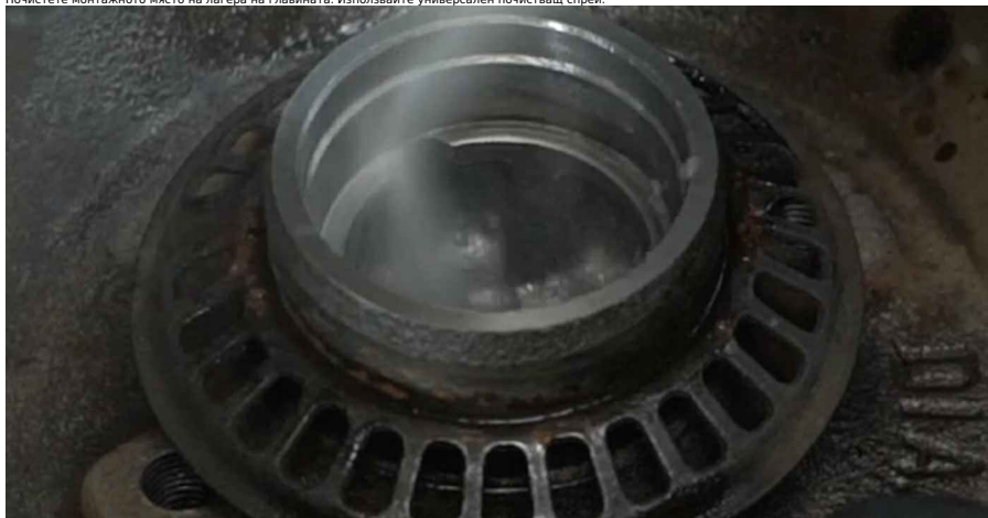
18 Монтирайте нов външен пръстен на колесния лагер в спирания барабан. Комплект дорници за втулки и лагери.
