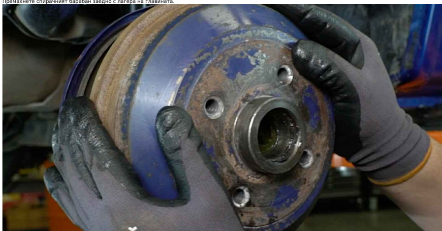
Смяна на лагер главина - VAUXHALL CORSAVAN Mk I (B). Съвет от AUTODOC:
