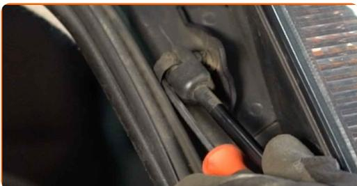
Смяна на: амортисьори за багажник – VAUXHALL Corsa Mk III (D) Хечбек (S07). Експертите на AUTODOC препоръчват:
