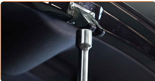
**3** Освободете зегеровия пръстен, свързващ газовия амортисьор с капака на багажника. Използвайте права отвертка.
