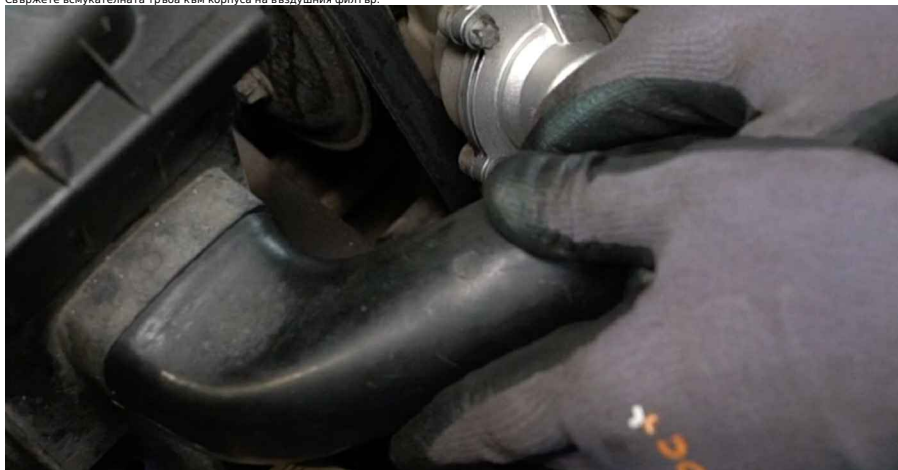
32 Закрепете фиксатора на маркуча на въздушния филтър.
