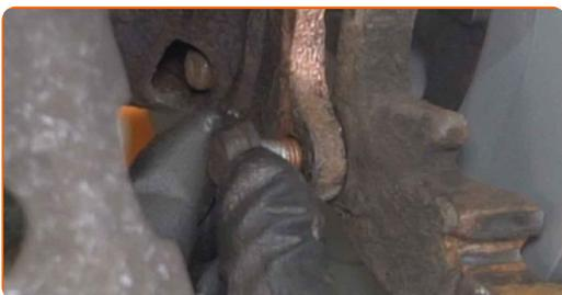
**23** Затегнете крепежните елементи на скобата на спирачния апарат. Използвайте тръбен ключ №14. Използвайте динамометричен ключ. Затегнете я с усилие от 57 Nm.
