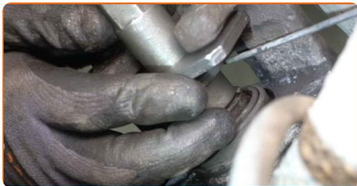
**26** Обработете спирачните накладки в областта, където повърхността им влиза в контакт със скобата на спирачния апарат. Използвайте грес против скърцане за спирачки.
