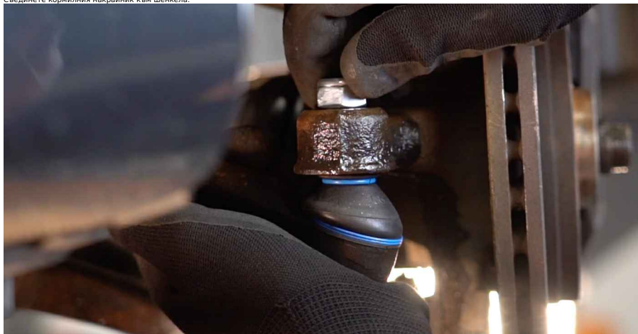
18 Затегнете закрепващата гайка, която свързва кормилния накрайник с шенкела. Използвайте тръбен ключ №17. Използвайте динамометричен ключ. Затегнете я с усилие от 33 Nm.
