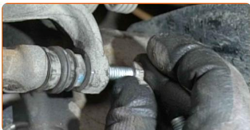
**19** Затегнете крепежните елементи на спирачния апарат. Използвайте тръбен ключ №13. Използвайте динамометричен ключ. Затегнете я с усилие от 35 Nm.
