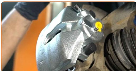
**20** Монтирайте фиксиращата пружина на спирачните накладки.
