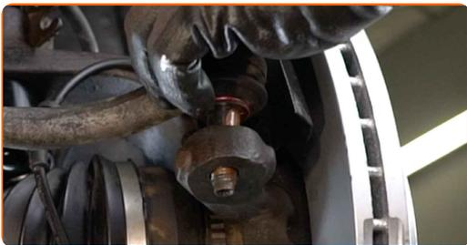
**70** Завийте крепежната гайка, която свързва кормилния накрайник с шенкела. Използвайте тръбен ключ №18. Използвайте тресчотен ключ.
