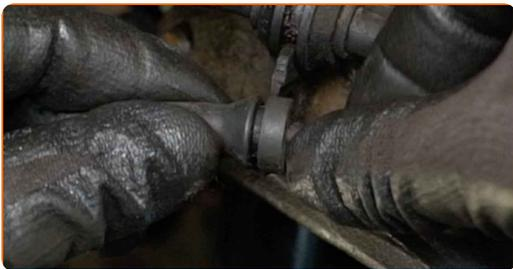
**73** Обработете конектора на ABS сензора. Използвайте диелектрична грес.
