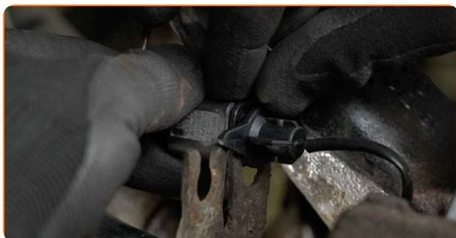
**30** Включете куплунга на датчика за износване на спирачните накладки.
