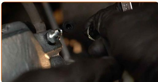
**30** Затегнете щуцера на спирачния апарат. Използвайте тръбен ключ №11. Използвайте динамометричен ключ. Затегнете я с усилие от 9 Nm.
