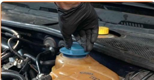
**54** Завийте капачката на резервоара за охладителна течност.
