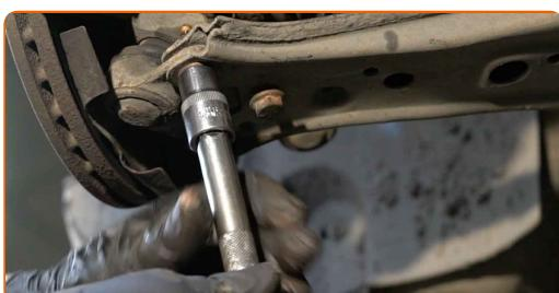
**55** Стегнете закрепването на шарнирния болт. Използвайте тръбен ключ №13. Използвайте динамометричен ключ. Затегнете я с усилие от 20 Nm.+90°
