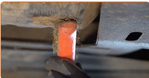
**7** Развийте пробката за източване. Използвайте квадратен накрайник за пробка на маслото № 8. Изполвайте тресчотен ключ.
