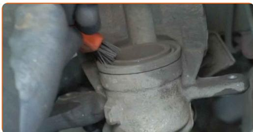
**15** Натиснете буталото на спирачния апарат. Използвайте инструмент за прибиране на спирачни цилиндри.
