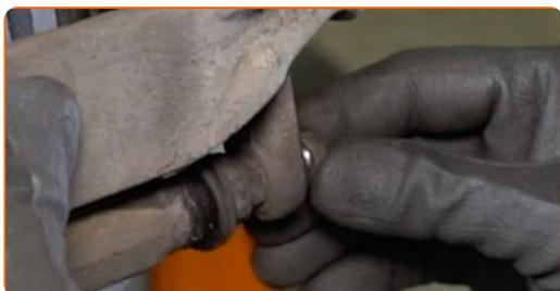
**21** Затегнете крепежните елементи на спирачния апарат. Използвайте комбиниран гаечен ключ №15. Използвайте тръбен ключ №13. Използвайте динамометричен ключ. Затегнете я с усилие от 35 Nm.
