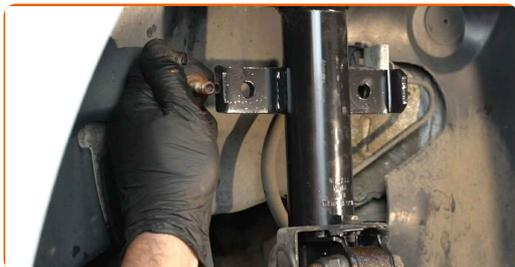
**51** Затегнете крепежния елемент, който свързва стабилизатора с макферсона. Използвайте тръбен ключ №16. Използвайте динамометричен ключ. Затегнете я с усилие от 44 Nm.
