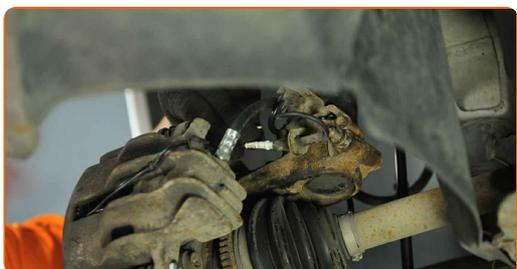
**77** Обработете крепежния елемент свързващ кормилния крайник с шенкела. Обработете крепежните елементи на шенкела. Обработете болтовете на скобата на спирачния апарат. Обработете крепежните елементи свързващи носача към шенкела. Използвайте медна грес.
