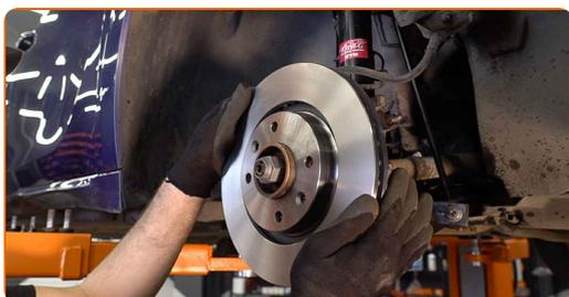
**22** Затегнете фиксиращите болтове на спирачния диск. Използвайте Torx T30. Използвайте динамометричен ключ. Затегнете я с усилие от 9 Nm.
