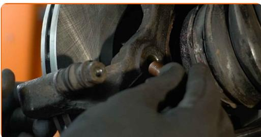
**29** Затегнете крепежните елементи на скобата на спирачния апарат. Използвайте тръбен ключ №19. Използвайте динамометричен ключ. Затегнете я с усилие от 105 Nm.
