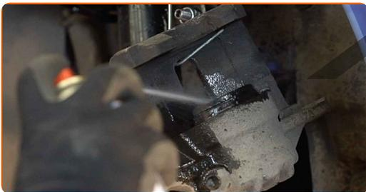
**19** Притиснете буталото в спирачния апарат. Използвайте инструмент за прибиране на спирачни цилиндри.
