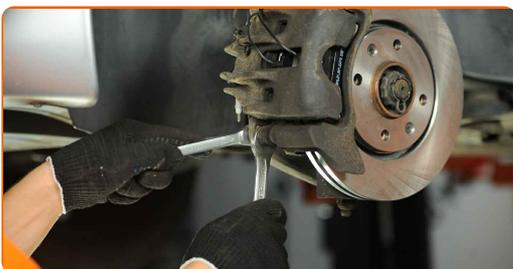
**23** Свържете кабела на датчика за износване на спирачната накладка.
