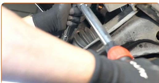
**81** Захванете закрепващата конзола на спирачния маркуч.
