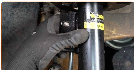
**85** Затегнете крепежния елемент, който свързва стабилизатора с макферсона. Използвайте тръбен ключ №17. Използвайте динамометричен ключ. Затегнете я с усилие от 43 Nm.
