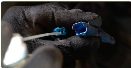
67 Закрепете конектора на ABS сензора.
