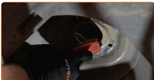
**53** Поставете амортизатора с пружината в нишата на колелото.
