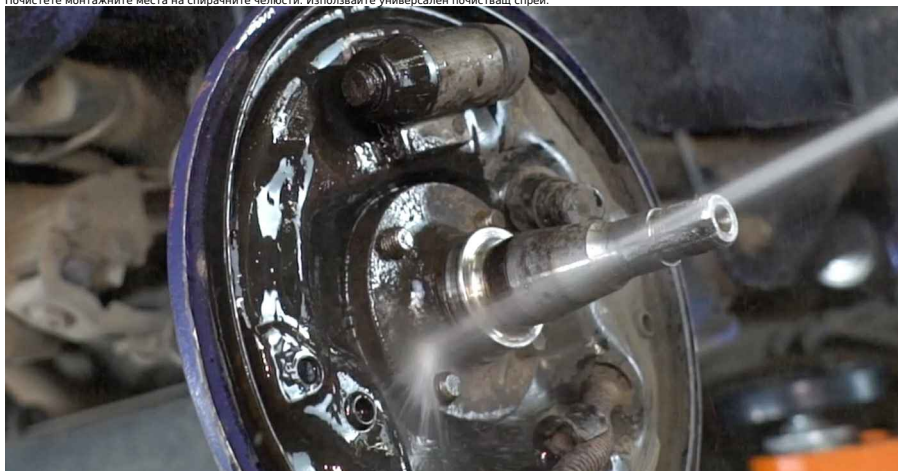
Смяна на: спирачни челюсти - OPEL Corsa C Ван (X01). Съвет от експертите на AUTODOC:
