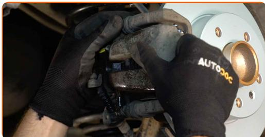
**32** Затегнете крепежните елементи на спирачния апарат. Използвайте комбиниран гаечен ключ № 17. Използвайте тръбен ключ №13. Използвайте динамометричен ключ. Затегнете я с усилие от 25 Nm.
