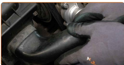
**32** Закрепете фиксатора на маркуча на въздушния филтър.
