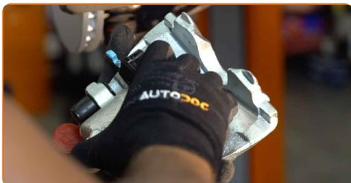
Смяна на: спирачен апарат – OPEL Astra H TwinTop (A04).
