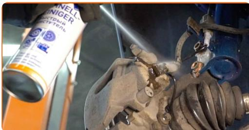
**Смяна на: спирачен апарат – OPEL Astra H TwinTop (A04). AUTODOC препоръчва:**
