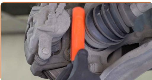
**11** Развийте крепежните елементи на скобата на спирачния апарат. Използвайте тръбен ключ №17. Използвайте тресчотен ключ.
