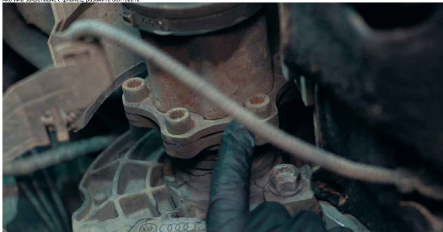
8 Ако има закрепване с фланец, развийте болтовете
