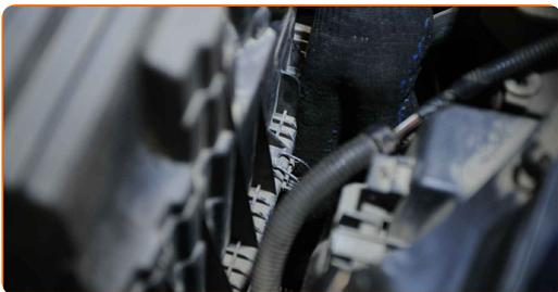
71 Включете конектора на датчика за разход на въздух.
