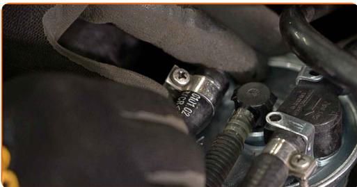
**15** Завийте крепежния елемент свързващ горивопровода към корпуса на горивния филтър. Използвайте кръстатата отвертка.
