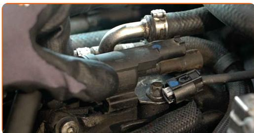
**22** Включете конектора на вакуумния клапан.
