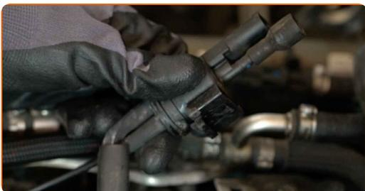
**7** Откачете конектора на датчика за вода в горивото.
