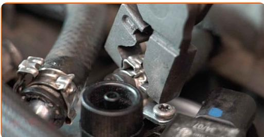
**20** Закрепете конектора на датчика за вода в горивото.
