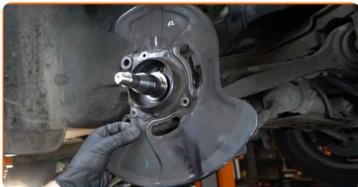
**47** Завийте предпазителя на спирачния диск. Използвайте тръбен ключ №E12. Използвайте динамометричен ключ. Затегнете я с усилие от 11 Nm.
