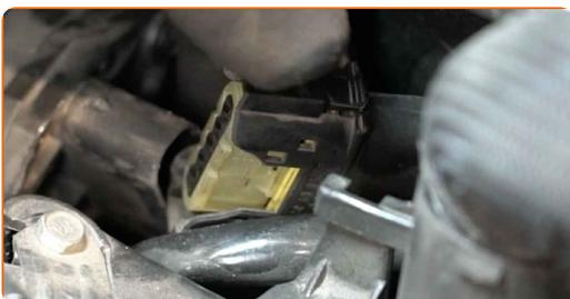
**8** Освободете фиксаторите държащи датчика за масов разход на въздух. Използвайте лост тип кози крак.
