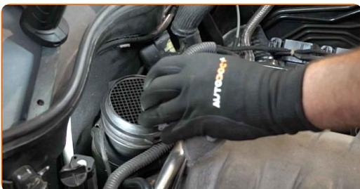
**12** Освободете фиксаторите държащи датчика за масов разход на въздух. Използвайте лост тип кози крак.
