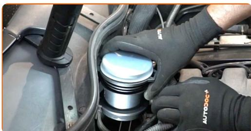
**15** Затворете фиксаторите на датчика за масов разход на въздух.
