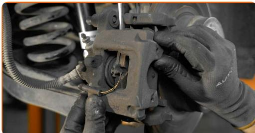
Смяна на: датчик за накладки – MERCEDES-BENZ E-класа T-modell (S211).
