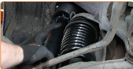
**38** Завийте крепежния елемент на буталния прът на макферсона.
