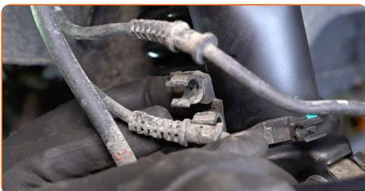
**43** Монтирайте скобите на тампоните на стабилизатора. Използвайте клещи за водна помпа.
